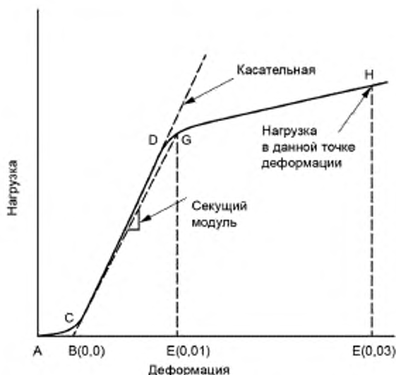
Рисунок Б.1 — График зависимости «нагрузка — деформация»
