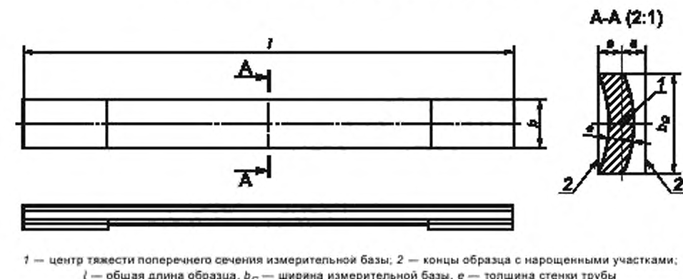
Рисунок 3 — Образец прямоугольной формы (для метода А)
