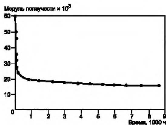
Рисунок X2.3 — Зависимость модуля ползучести от времени
