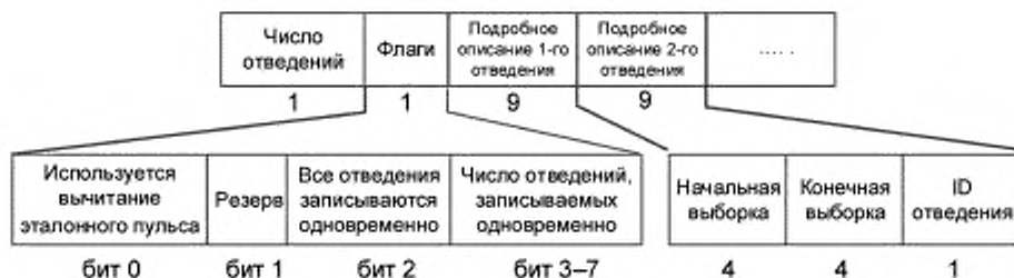
Рисунок 6 — Обзор части данных раздела определения отведения ЭКГ
