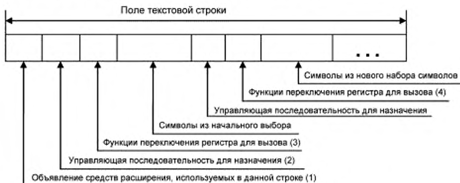
Рисунок А.5 — Структура поля текстовой строки (ИСО/МЭК 2022)
