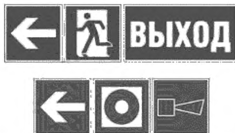
Рисунок 6 — Примеры формирования смысловой комбинации знаков для указания направления движения
