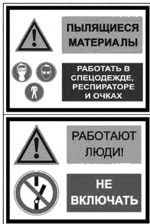
Рисунок 5 — Примеры выполнения комбинированных знаков безопасности
