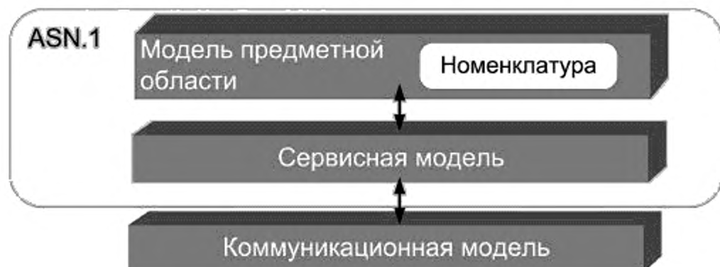
Рисунок 5 — Базовые блоки моделирования в стандарте ИСО/МЭК 11073-20601
