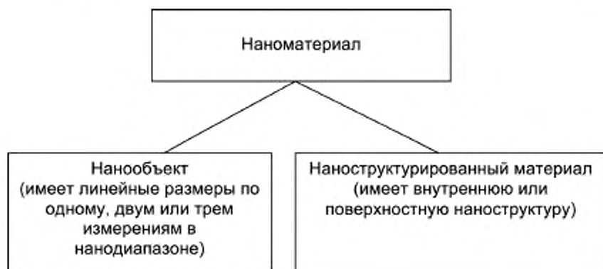
Рисунок 1 — Пример иерархической взаимосвязи определений терминов «наноматериал», «нанобъект» и «наноструктурированный материал»
