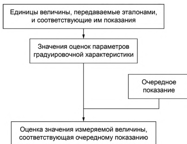
Рисунок 6 — Модель двухступенчатого измерения, включающего построение калибровочной характеристики и ее применение к показаниям измерительной системы
