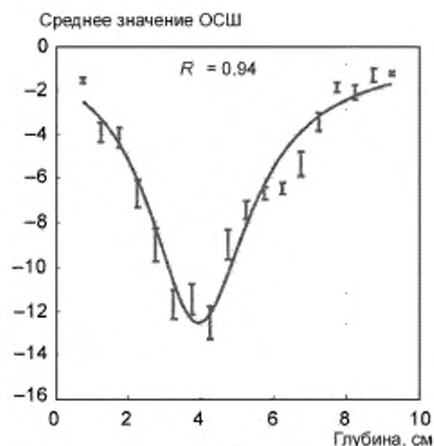
а Средние значения ОСШ (ОСШ с ) в зависимости от глубины для фантома в среднем с одной слабоотражающей сферой диаметром 3,2 мм на миллилитр
