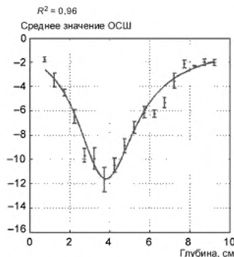
а Средние значения ОСШ (ОСШ с ) в зависимости от глубины для фантома в среднем с двумя слабоотражающими сферами диаметром 3,2 мм на миллилитр
