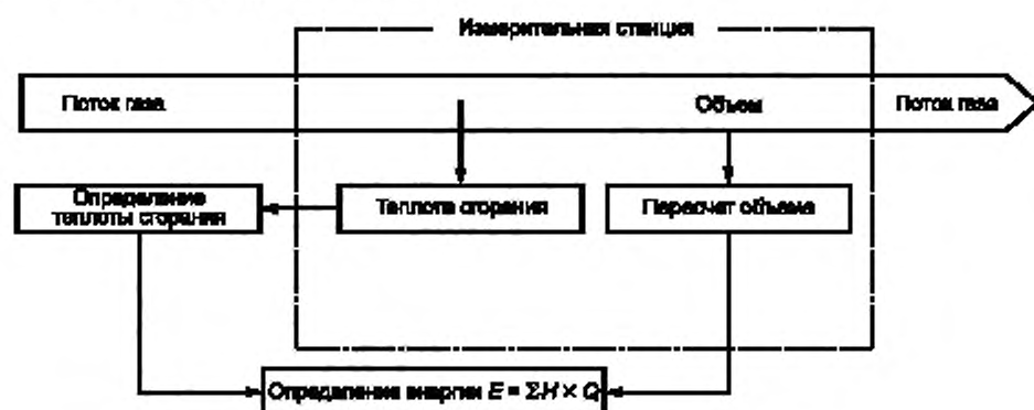
Рисунок 7 — Локальное офлайн определение теплоты сгорания
