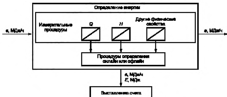
Рисунок 2 — Схема определения энергии косвенным методом
