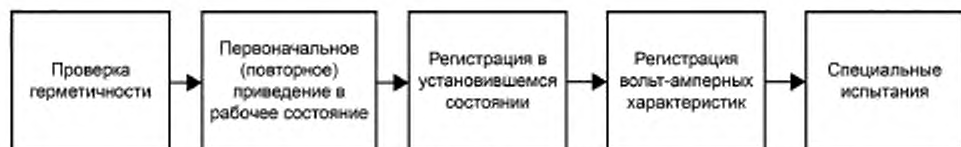
Рисунок 2 — Типовая последовательность операций при проведении испытаний
