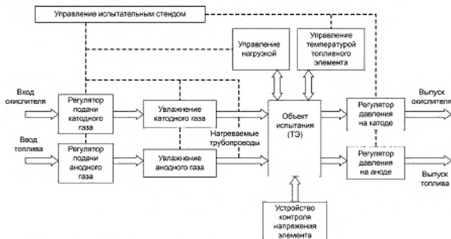
Рисунок 1 — Принципиальная схема стенда для испытания единичного элемента
