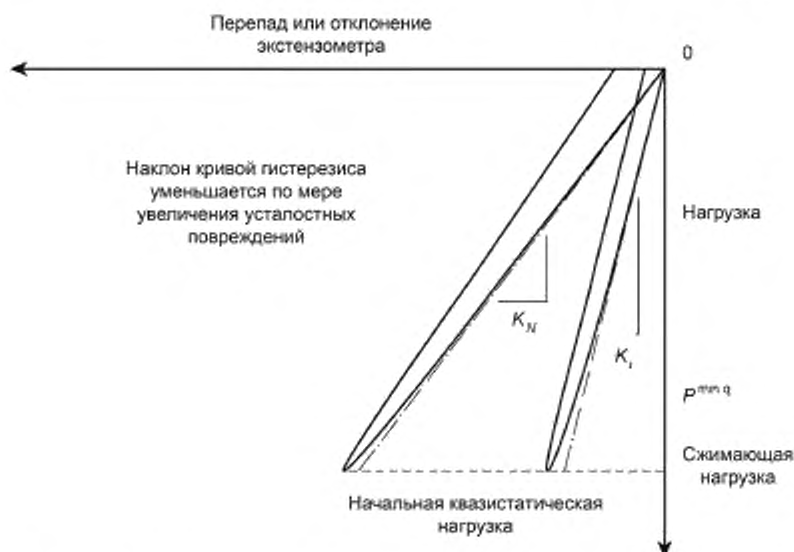
Рисунок 2 — Типичные графики зависимости сжимающего усилия от отклонения с изображением формы и параметров кривой гистерезиса
