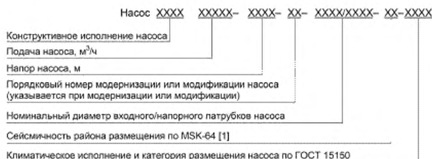
Рисунок 1 — Схема условного обозначения насоса
