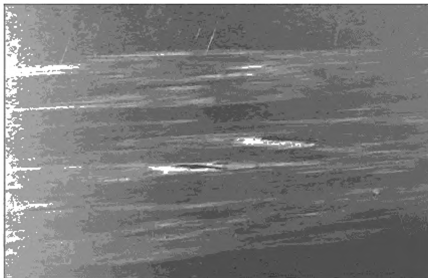
Рисунок А.40 — Включения в лаковом (эмалевом) покрытии
