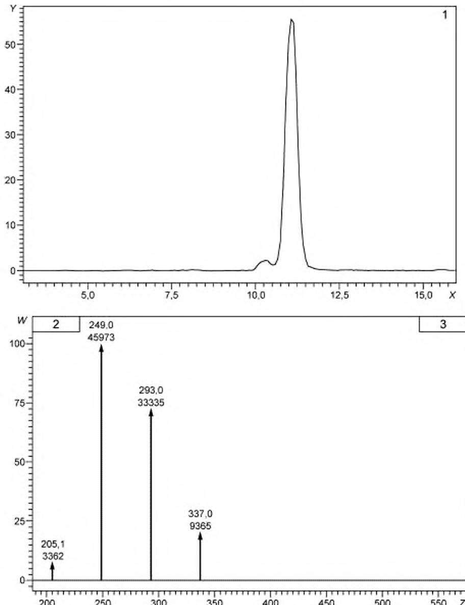
X — минуты; Y — килоимпульсы/kcounts; Z — m/z сигнал; W — килоимпульсы/kcounts; 1 — отфильтрованная интенсивность основного пика, std002.xms; 2 — спектр 1А базовая точка: 249,0 (45 973 = 100 %), std001.xms; 3 — 11,040 min, спектрограмма: 955, объединенная воспроизведенная хроматограмма: 92 588, компьютер с байтовой организацией
