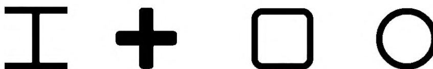
д) Поперечные сечения стальных свай
