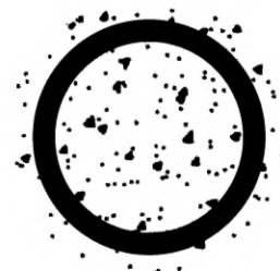
с) Поперечное сечение набивной сваи с извлекаемой обсадной трубой
