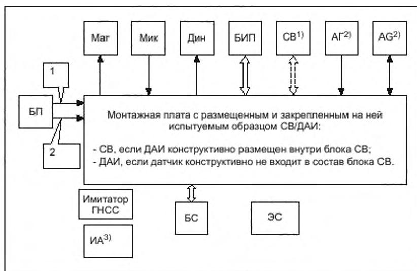
Маг – аудиосистема ТС; Мик – микрофон; Дин – динамик; БИП – блок интерфейса пользователя СВ; ДАИ – блок датчика аварии; АГ – антенна ГНСС; АГ – антенна GSM/UMTS; БП – блок питания (12/24 В); БС – блок сопряжения; ЭС – эмулятор системы экстренного реагирования при авариях; ИА – имитатор аварии; 1 – кабель питания; 2 – цепь зажигания
