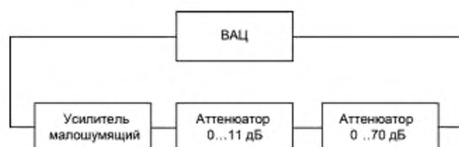
Рисунок В.2 — Схема калибровки тракта
