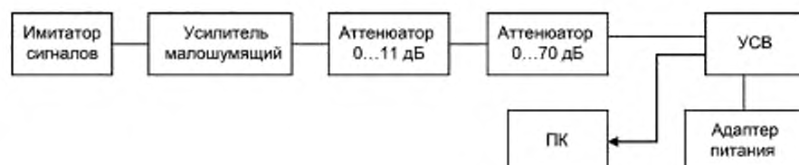
Рисунок В.3 — Схема определения чувствительности модуля ГНСС
