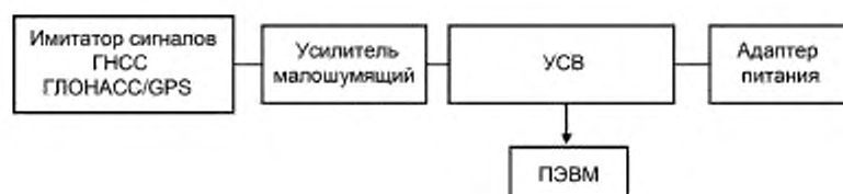
Рисунок В.1 — Схема испытательного стенда
