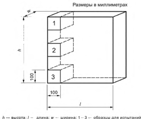
Рисунок В.1 — Схема выпиливания образцов для определения прочности при сжатии
