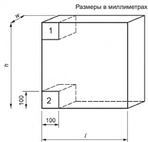
Рисунок В.2 — Схема выпиливания образцов для определения морозостойкости
