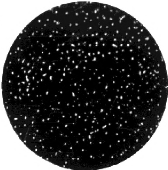
Шкала для оценки цементитной сетки в инструментальной нелегированной стали (500 \times )
