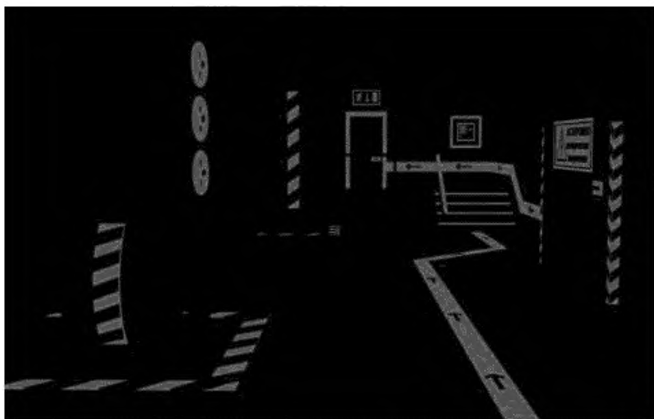
Рисунок Б.12 – Пример обозначения элементами ФЭС того же производственного помещения после отключения освещения
