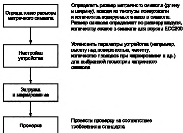
Рисунок 10 — Блок-схема определения параметров маркирования лазером
