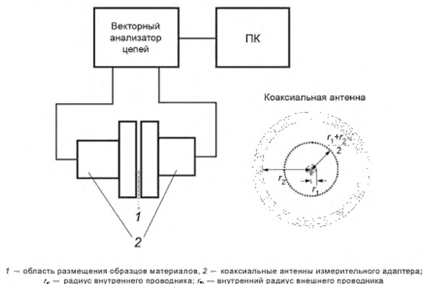
Рисунок 8 — Схема испытательного стенда для оценки экранирующих материалов
