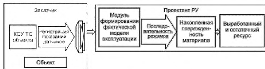
Рисунок 12 — Схема организации работ при эксплуатации СЭМР
