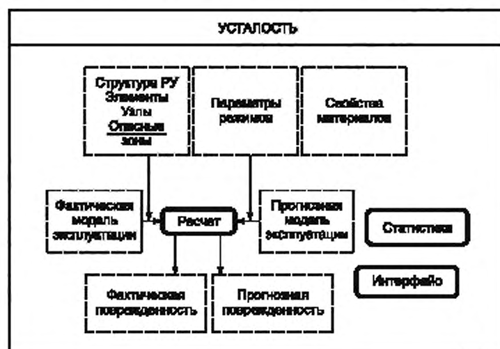
Рисунок 7 — Схема работы расчетного модуля «Усталость»
