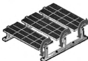
Рисунок 1 — Пример одноосной системы слежения за Солнцем с горизонтальной осью вращения
