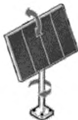
Рисунок 7 — Пример двухосной системы слежения за Солнцем с вертикальной основной осью
