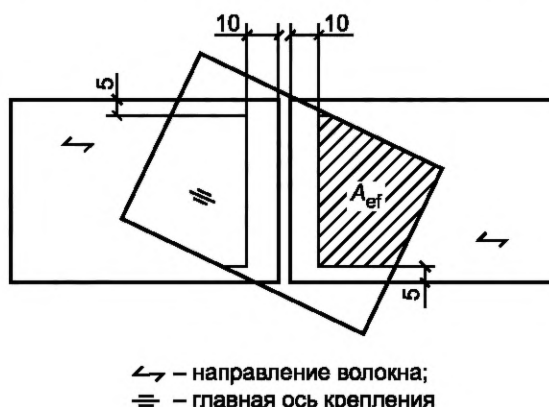
Рисунок 1 — Определение эффективной площади металлической пластины
