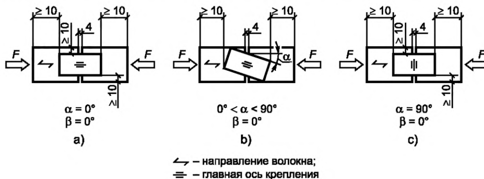
Рисунок 5 — Образец для определения прочности пластин на сжатие
