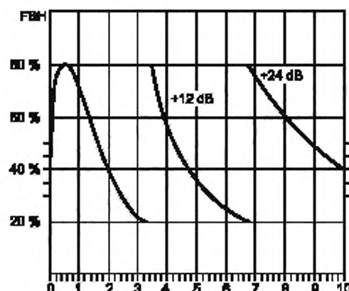
Рисунок 9 — Экран ультразвукового прибора, показывающего разделение DAC-кривой
