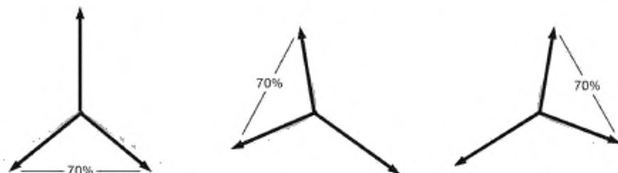
Рисунок 3с) — Испытание «фаза—фаза» — допустимый метод 2, фазовый сдвиг
