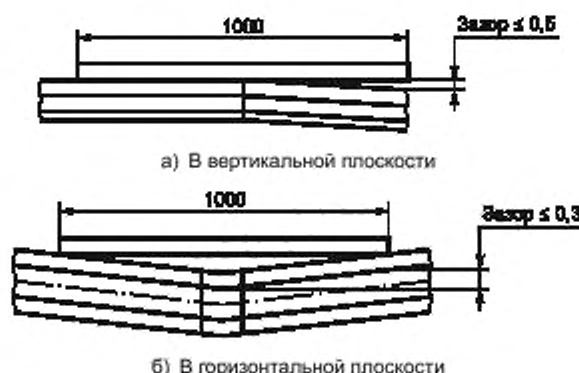
Рисунок 5 — Схема контроля прямолинейности рельсов
