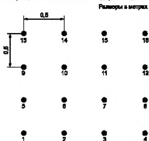
Рисунок D.1 — Позиции измерительной антенны (датчика) в плоскости однородного поля
