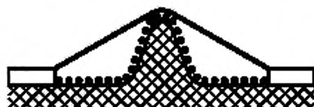
Рисунок В.3 — Прорезь V-образной формы
