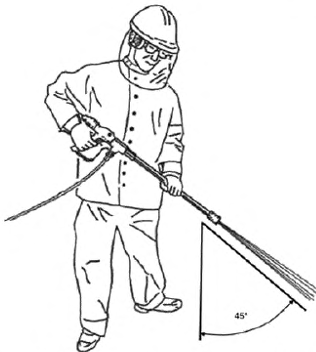
Рисунок DD.5 – Рабочие условия. Положение распыляющего устройства
