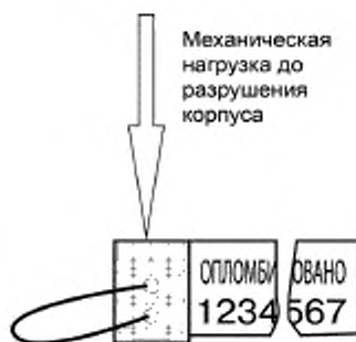
Рисунок Б.1 — Пример повреждения проволочной роторной пломбы
