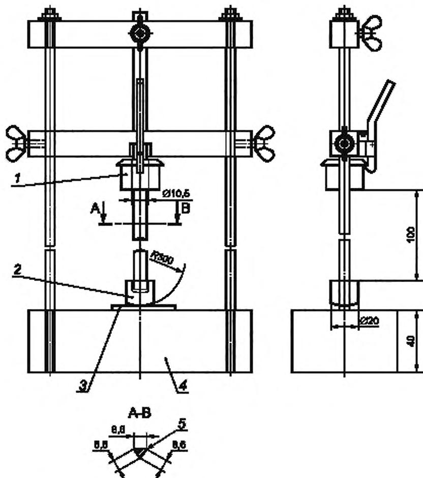
1 — ударник; 2 — промежуточный стальной груз массой 100 г; 3 — испытуемый образец; 4 — стальное основание массой 10 кг;
