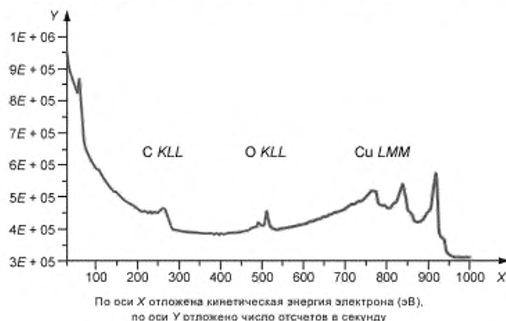
Рисунок А.1 — До распыления ионным пучком. Спектр, полученный непосредственно
