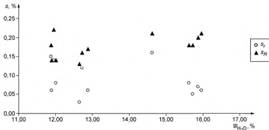
$s$  — стандартное отклонение;  $s_r$  — стандартное отклонение повторяемости;  $s_R$  — стандартное отклонение воспроизводимости;  $\bar{W}_{H_2O}$  — среднее значение содержания влаги
