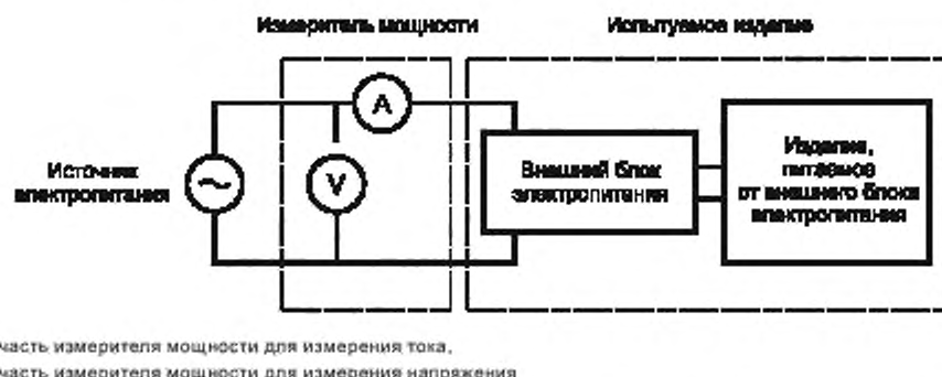
Рисунок В.4 — Схема расположения прибора, питаемого от внешнего источника электропитания для нагрузок большой мощности
