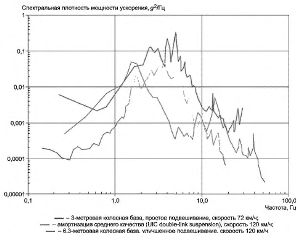
Рисунок 1 — Жесткость вибрации в вертикальном направлении (Британские железные дороги)
