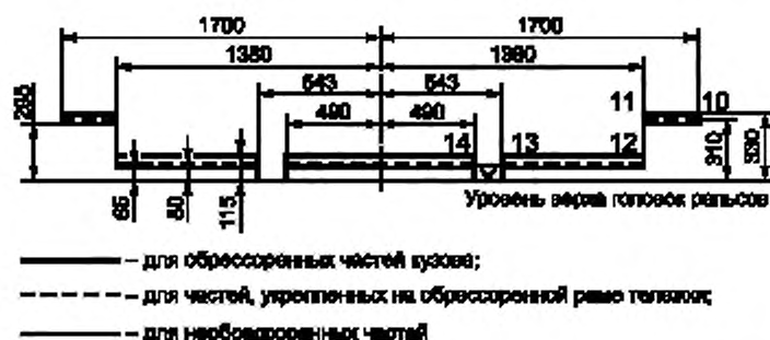
Рисунок Б.2 — Нижняя часть габарита подвижного состава для эксплуатации на колее 1067 мм
