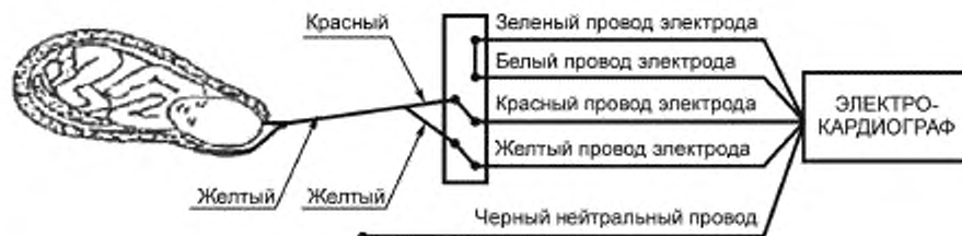
Рисунок ВВ.2 — Положение и цвет кодировки ЭЛЕКТРОДОВ на головке плода (см. таблицу ВВ.2)
