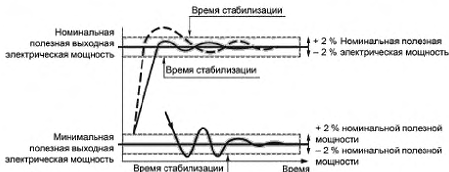
Рисунок 12 — Пример критериев стабилизации изменения электрической мощности
