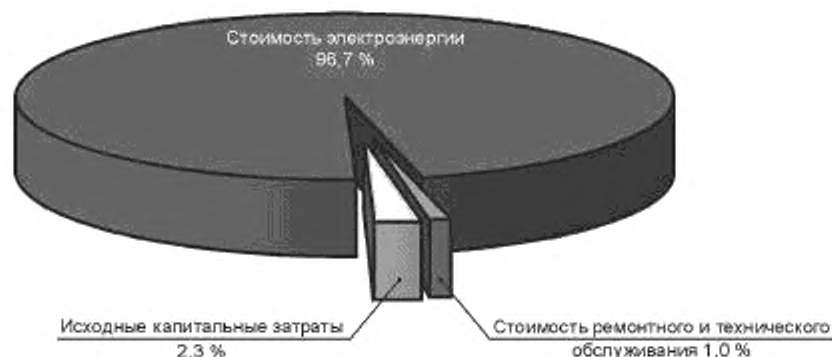
Рисунок 12 — Структура затрат на электродвигатель класса энергоэффективности IE3 мощностью 11 кВт, со сроком службы 15 лет, эксплуатируемый при полной нагрузке 4000 часов в год
