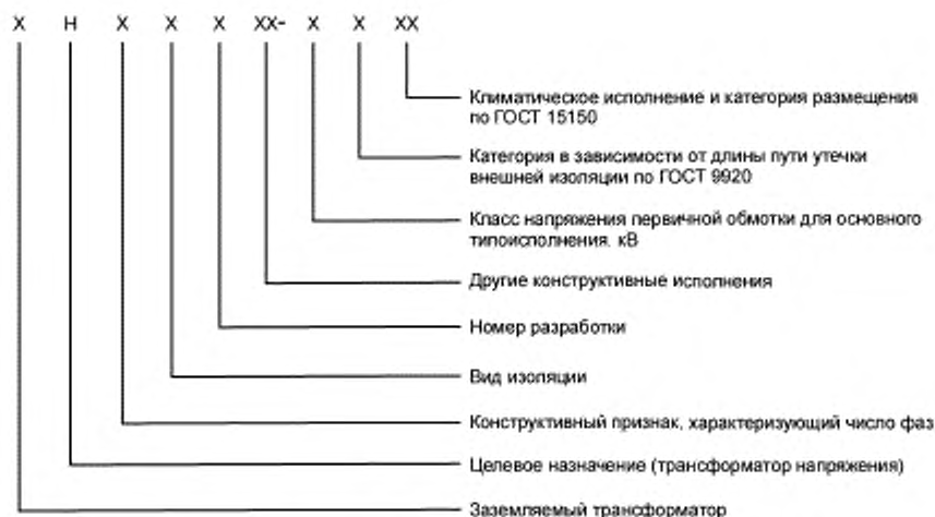
5.11 Условное обозначение трансформатора:
