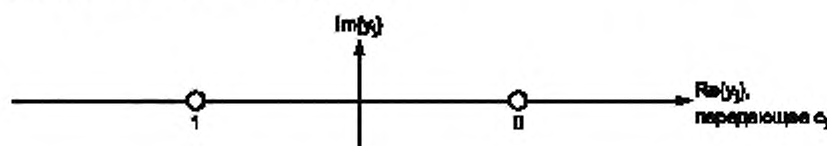
Рисунок 7 — Отображение ячейки на диаграмму созвездия BPSK
