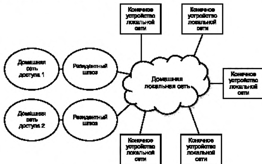
Рисунок 2 — Структурная схема модели домашней локальной сети
