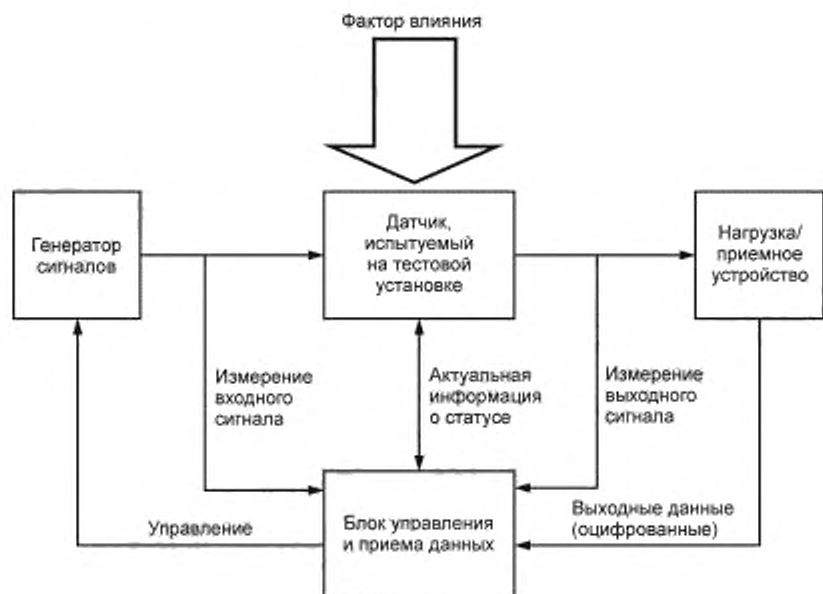
Рисунок 2 — Базисная схема установки для проведения тестовых испытаний
