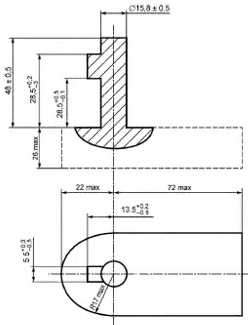
Примечание — Бордок ключа должен по всему контуру свободно входить в гнездо и обеспечивать запирание фиксирующего устройства.
