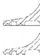
Рисунок 4 — Типичный профиль с мелкими канавками под ребром
