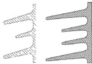
Рисунок 6 — Типичный профиль с переменным вылетом ребра
