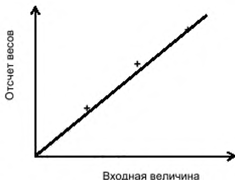
Рисунок 1 — Проверка линейности отсчета весов как функции входной величины
