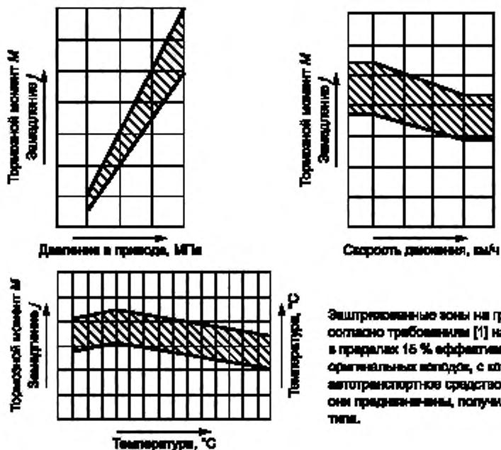
Заштрихованные зоны на графиках согласно требованиям [1] находятся в пределах 15 % эффективности оригинальных маноблоков, с которыми автотранспортное средство, для которого они предназначены, получило одобрение типа.
